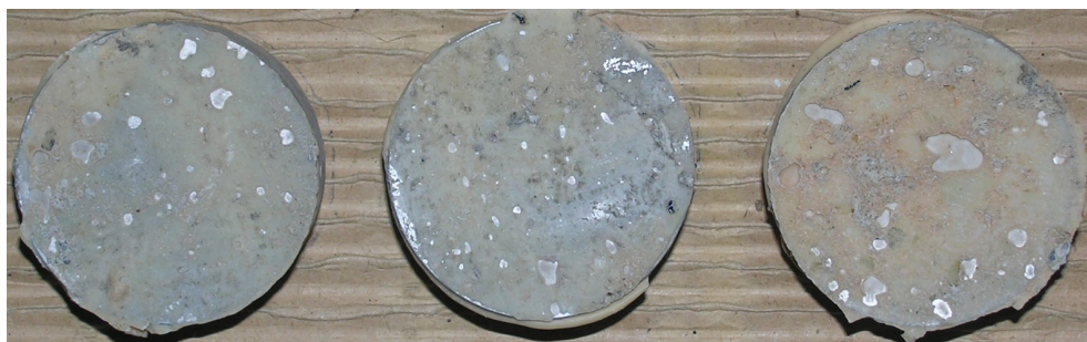
Obr.F86-207 Zkušební terče číslo 3, 126, 174 (zkušební místo 8) po provedení odtrhu.
