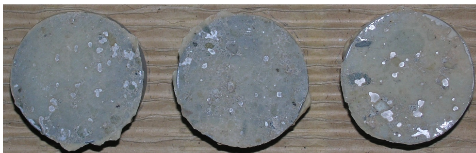
Obr.F86-206 Zkušební terče číslo 44, 69, 178 (zkušební místo 7) po provedení odtrhu.
