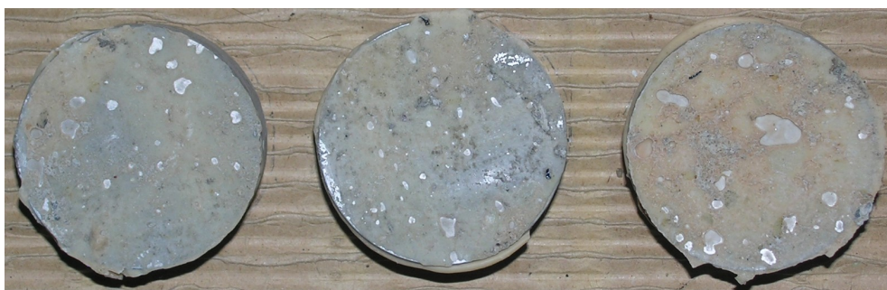
Obr.F86-202 Zkušební terče číslo 6, 98, 113 (zkušební místo 3) po provedení odtrhu.
