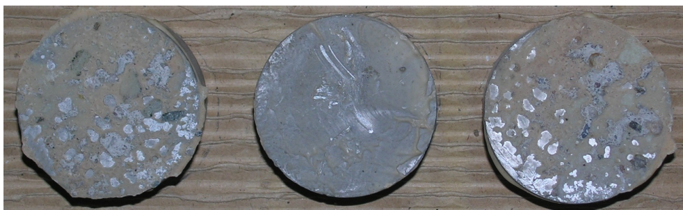
Obr.F86-201 Zkušební terče číslo 66, 116, 172 (zkušební místo 2) po provedení odtrhu.
