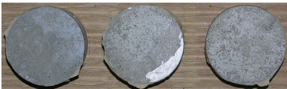
Obr.F86-207 Zkušební terče číslo 82, 164, 192 (zkušební místo 9) po provedení odtrhu.
