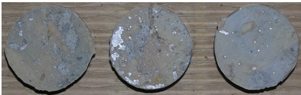
Obr.F86-205 Zkušební terče číslo 129, 177, 191 (zkušební místo 6) po provedení odtrhu.
