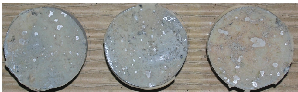
Obr.F86-203 Zkušební terče číslo 105, 161, 163 (zkušební místo 4) po provedení odtrhu.
