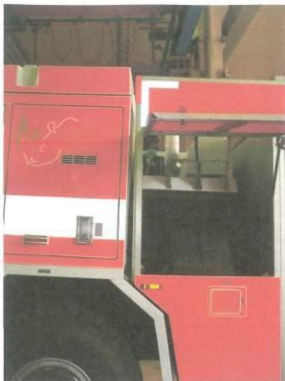
Obr.13 Viditelně nesouměrná spára mezi částmi nástavby, levá strana
