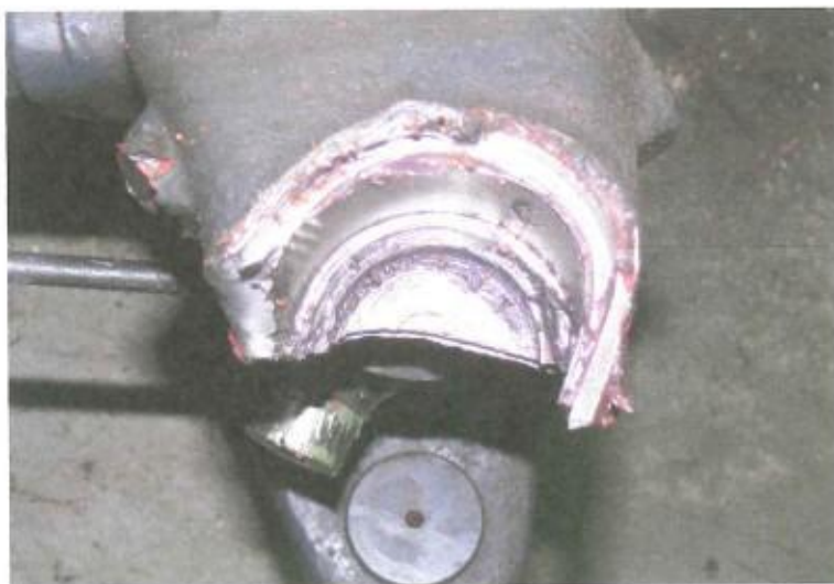
Obr.4 Rozlomené lůžko horního čepu, pohled shora
