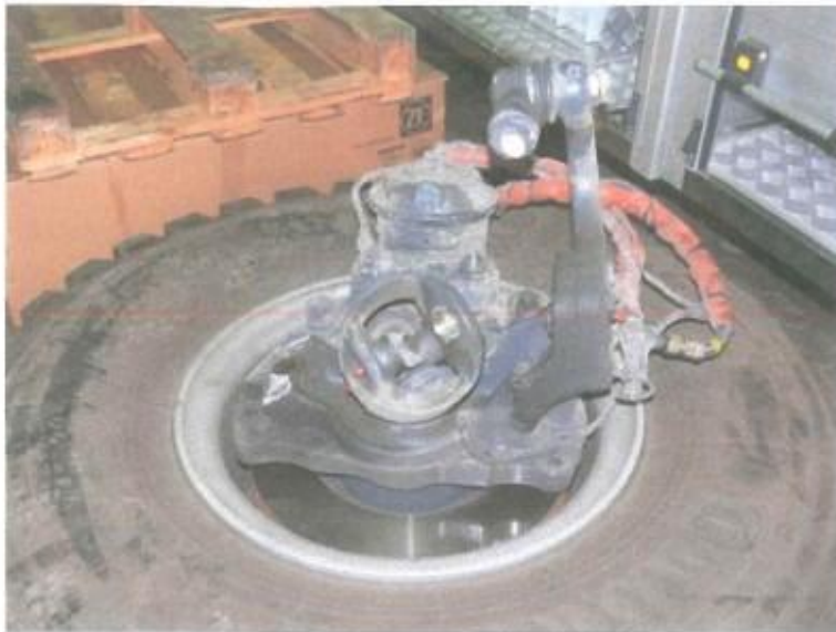
Obr.9 Přední kulový čep pravého táhla řízení na páce řízení odlomeného kola a rozlomený homokinetický kloub
