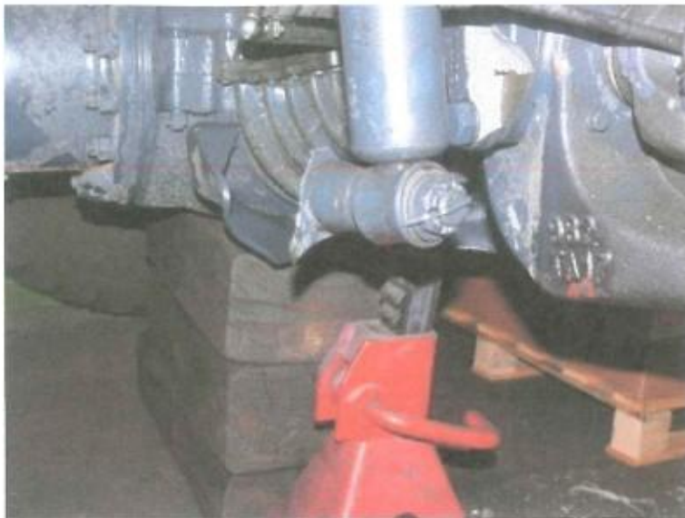
Obr.7 Odlomený spodní čep (držák) tlumiče pérování
