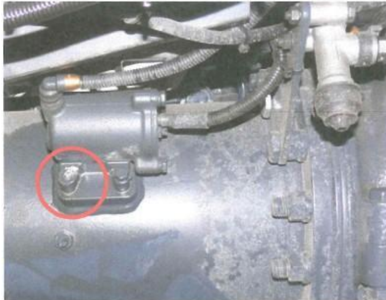
Obr.10 Odlomená hlava připevňovacího šroubu ovládacího válce řazení uzávěrky předního diferenciálu
