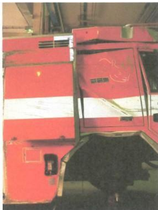
Obr.14 Viditelně nesouměrná spára mezi částmi nástavby, levá strana
