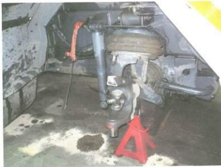
Obr.2 Celkový pohled na poškozenou pravou přední polonápravu
