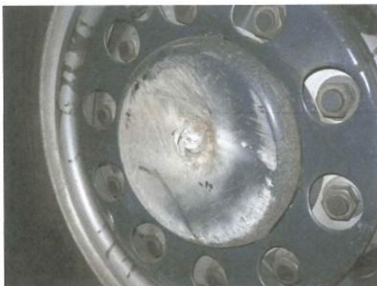
Obr.12 Sedřený kryt a hlavice dohušťovací trubky centrálního huštění pravého kola třetí nápravy
