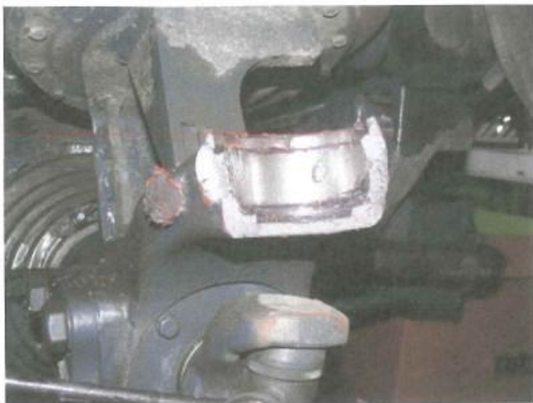
Obr.3 Rozlomené lůžko horního čepu a otačený zadní doraz na rozvidlení polonápravy
