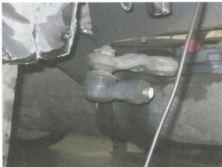
Obr.8 Zadní kulový čep odlomeného pravého táhla řízení
