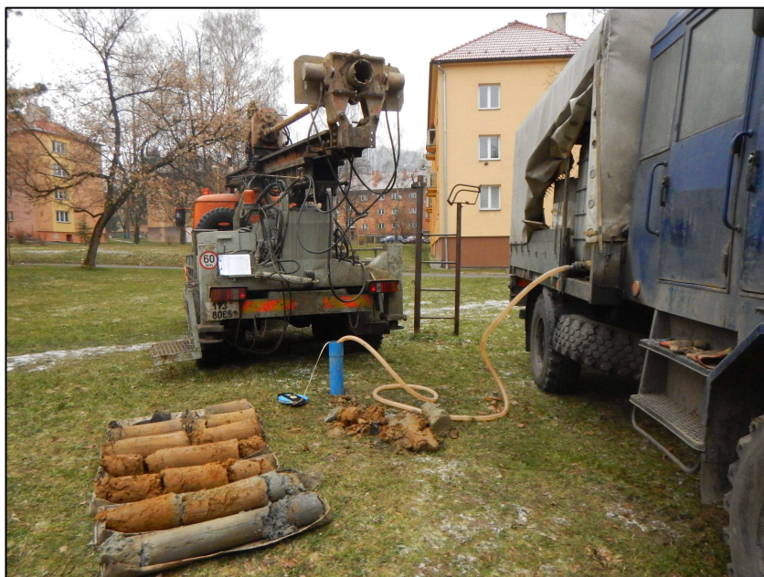
Obrázek 7: Vsakovací zkouška na vrtu SK-1
