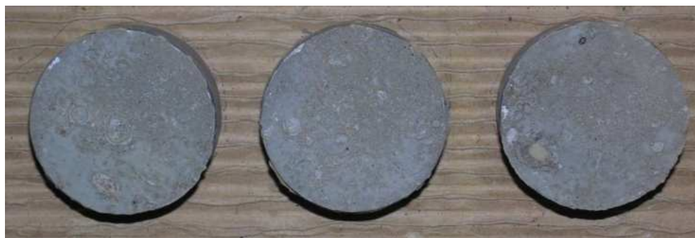
Obr.F87-216 Zkušební terče číslo 24, 43, 57 (zkušební místo 6) po provedení odtrhu.
