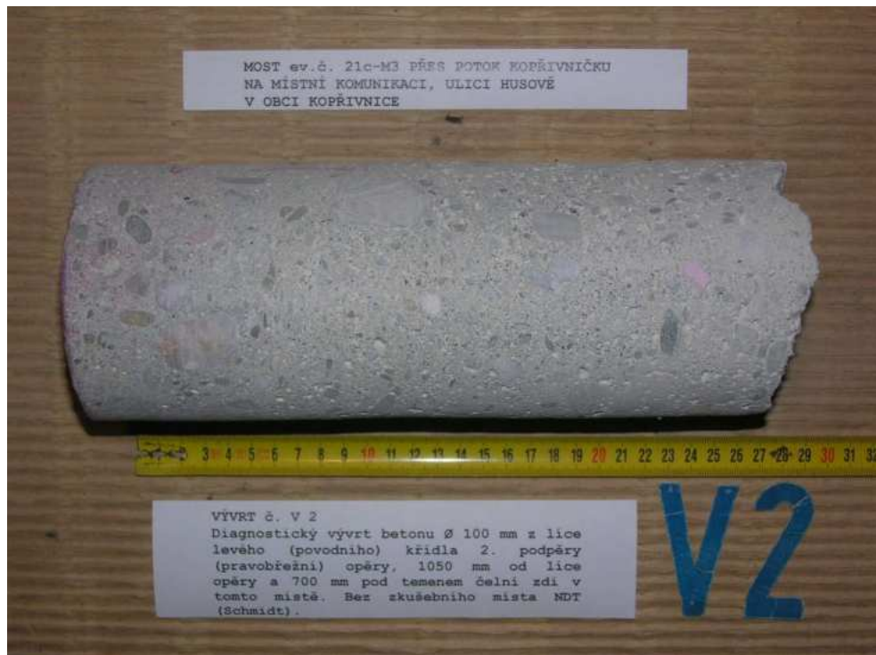
Obr. F84-102 VÝVRT č. V2. Diagnostický vývrt betonu Ø 100 mm z líce levého (povodního) křídla 2. podpěry (pravobřežní) opěry, 1050 mm od líce opěry a 700 mm pod temenem čelní zdi v tomto místě. Bez zkušebního místa NDT (Schmidt).
