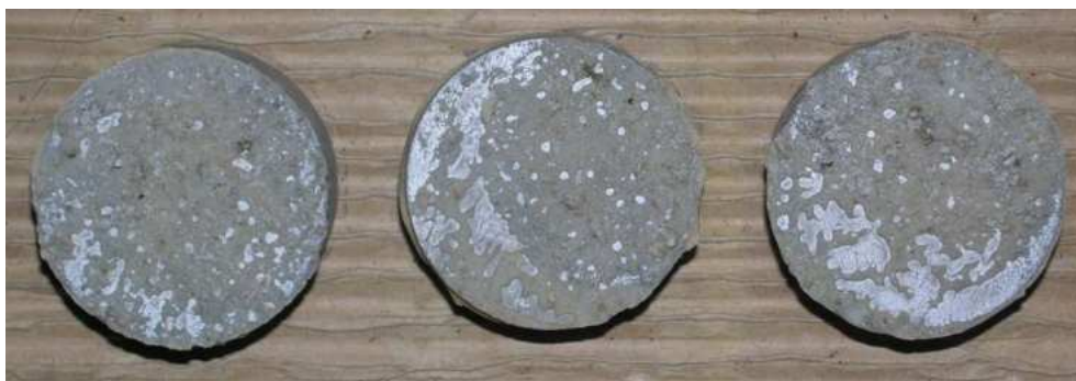
Obr.F87-214 Zkušební terče číslo 25, 95, 131 (zkušební místo 4) po provedení odtrhu.
