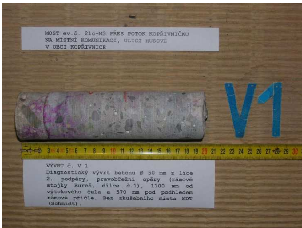
Obr. F84-101 VÝVRT č. V 1. Diagnostický vývrt betonu Ø 50 mm z líce 2. podpěry, pravobřežní opěry (rámové stojky Bureš, dílce č.1), 1100 mm od výtokového čela a 570 mm pod podhledem rámové příčle. Bez zkušebního místa NDT (Schmidt).
