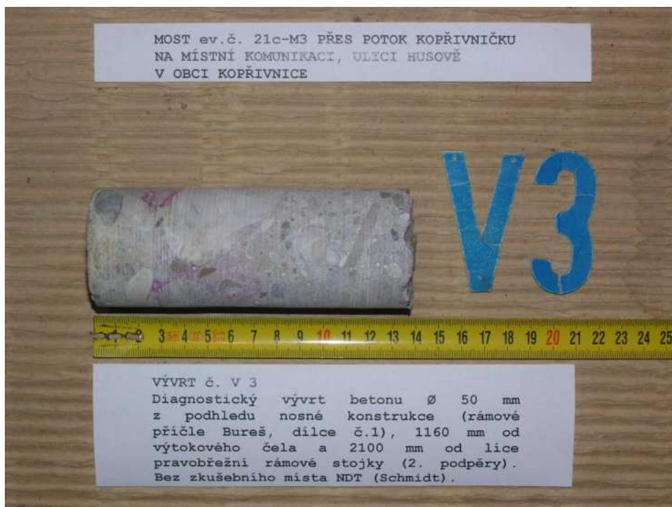
Obr. F84-103 VÝVRT č. V3. Diagnostický vývrt betonu Ø 50 mm z pohledu nosné konstrukce (rámové příčle Bureš, dílce č.1), 1160 mm od výtokového čela a 2100 mm od líce pravobřežní rámové stojky (2. podpěry). Bez zkušebního místa NDT (Schmidt).
