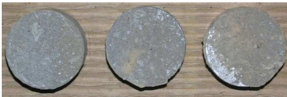
Obr.F87-219 Zkušební terče číslo 70, 124, 187 (zkušební místo 9) po provedení odtrhu.
