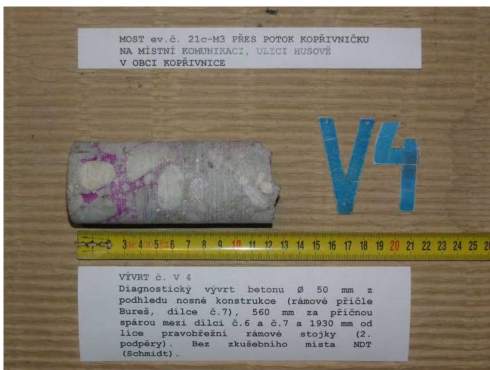
Obr. F84-104 VÝVRT č. V4. Diagnostický vývrt betonu Ø 50 mm z pohledu nosné konstrukce (rámové příčle Bureš, dílce č.7), 560 mm za příčnou spárou mezi dílci č.6 a č.7 a 1930 mm od líce pravobřežní rámové stojky (2. podpěry). Bez zkušebního místa NDT (Schmidt).
