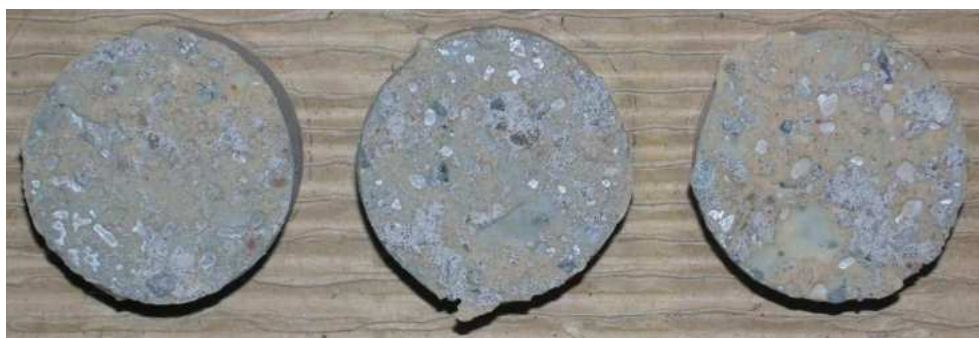
Obr.F87-211 Zkušební terče číslo 14, 65, 184 (zkušební místo 1) po provedení odtrhu.
