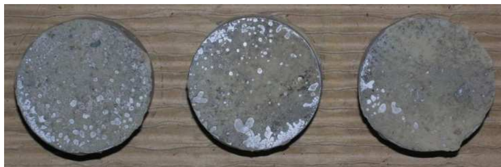
Obr.F87-213 Zkušební terče číslo 38, 122, 139 (zkušební místo 3) po provedení odtrhu.
