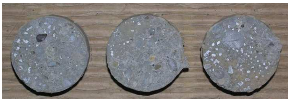
Obr.F87-215 Zkušební terče číslo 2, 59, 143 (zkušební místo 5) po provedení odtrhu.
