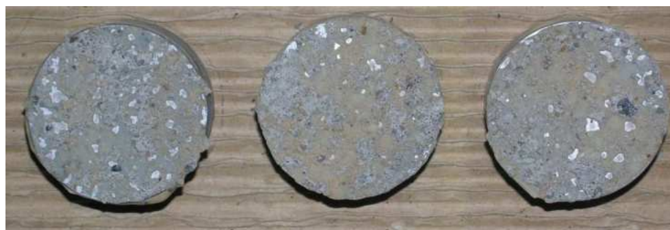
Obr.F87-212 Zkušební terče číslo 46, 158, 168 (zkušební místo 2) po provedení odtrhu.
