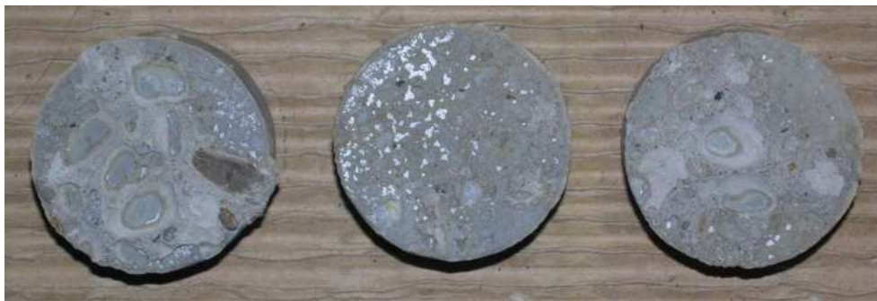
Obr.F87-218 Zkušební terče číslo 16, 21, 106 (zkušební místo 8) po provedení odtrhu.
