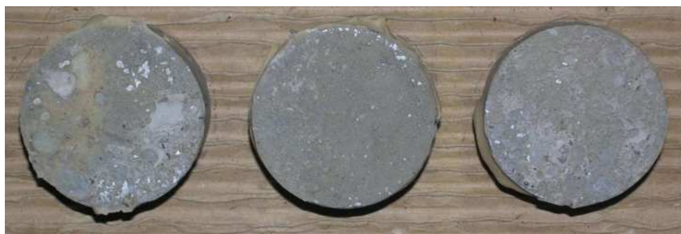
Obr.F87-217 Zkušební terče číslo 6, 11, 118 (zkušební místo 7) po provedení odtrhu.
